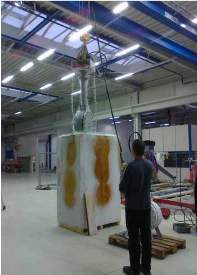
Cryotest für Linde Luftzerlegungsanlage; Anwendung: Sauerstoff -196°C Cryotest Linde air separation unit; application: oxygen -196 °C
